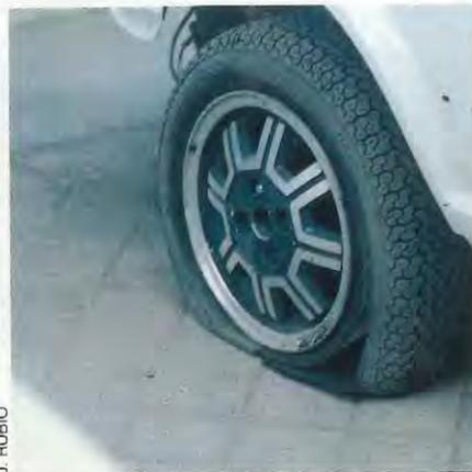
Una rueda con sólo medio kilo de presión, a 120 Km/h., reventará por las altísimas temperaturas que se producen con el rozamiento.
