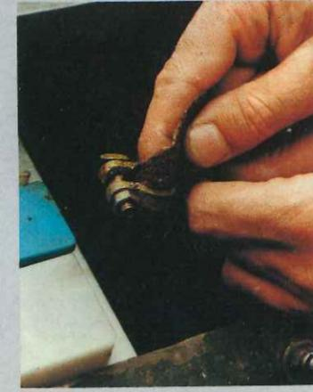
**L**a polaridad de los terminales de las baterías les convierte en elementos químicos muy activos. Es necesario revisarlos y limpiarlos con cierta frecuencia. Después, conviene colocarles algún tipo de protección.
