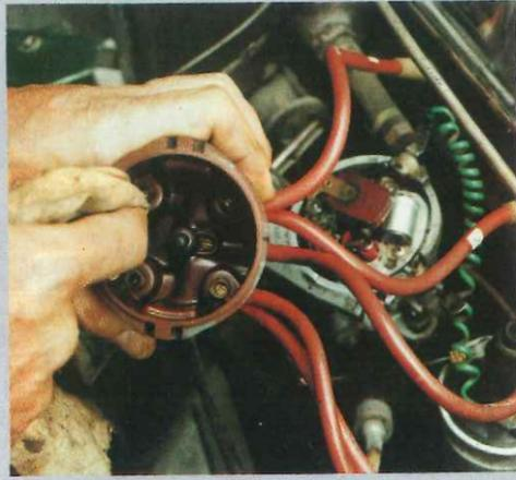
**E**n los distribuidores clásicos, al igual que en los sistemas dotados de encendido electrónico, todos los contactos deben estar absoluta y perfectamente limpios.
