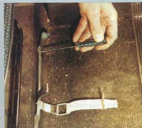
**L**OS soportes de un extintor deben fijarse de forma sólida a la estructura del vehículo, teniendo en cuenta que a lo largo del uso del mismo soportarán vibraciones, golpes, etcétera en un uso que tenemos que prever que sea duro.
