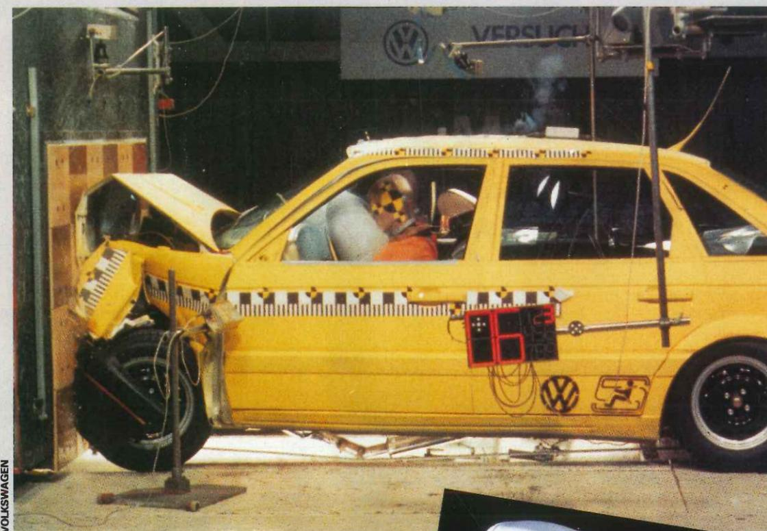
En los «crash-test», o choques de ensayo, son torturados todos los elementos de seguridad de un coche.
