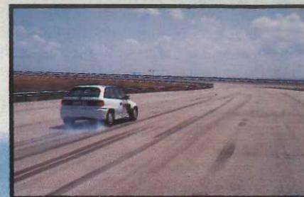
¿Sabía usted que durante el segundo que transcurre desde que un conductor es consciente de una situación de peligro hasta que comienza a pisar el freno el vehículo recorre —¡sin hacer nada para evitarlo!— más de 33 metros, si va a 120 km/h? ¿Y que, ya en plena frenada, puede no tener suficiente con el equivalente a un estadio de fútbol para detenerse? La revista TRAFICO ha frenado para usted en 240 ocasiones con nueve vehículos distintos (pequeños, medianos y grandes)
