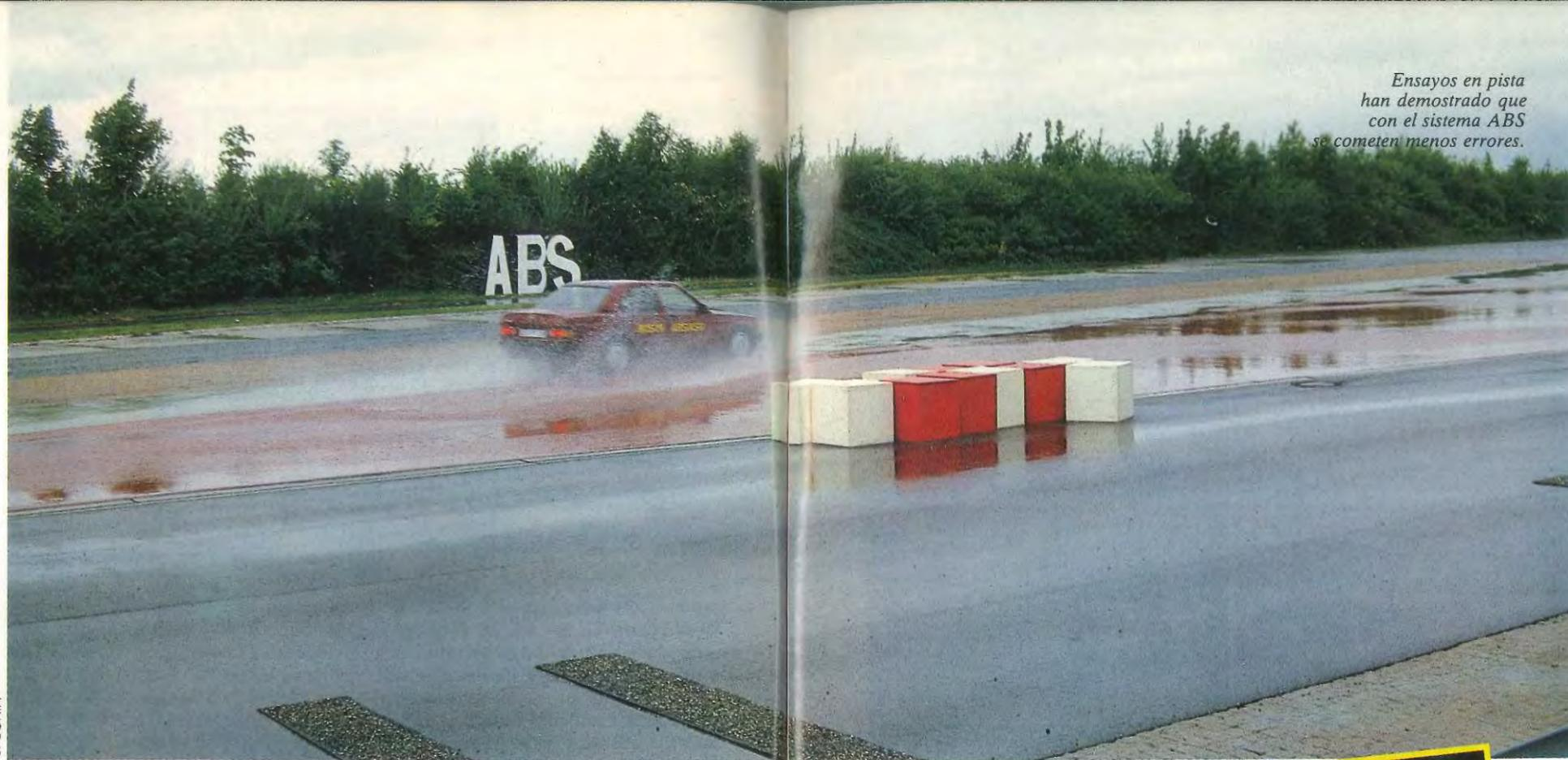
Ensayos en pista han demostrado que con el sistema ABS se cometen menos errores.
