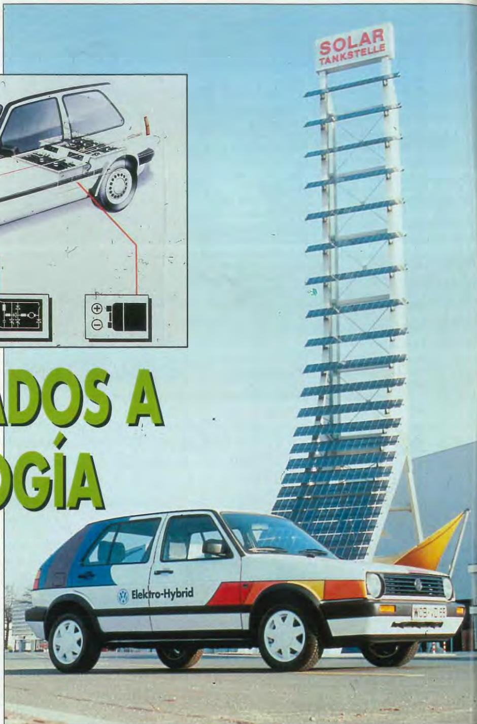
Una gasolinera «solar»: las placas recogen la energía del Sol y la acumulan en baterías donde luego se recargan los vehículos.
