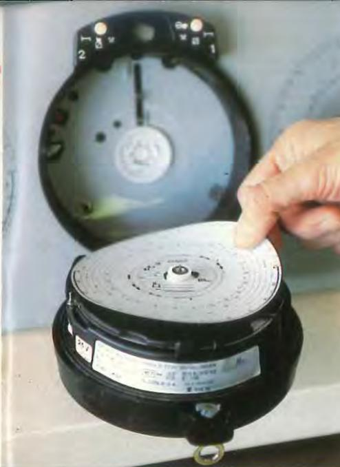
En los tacógrafos para dos conductores, el disco diagrama inferior corresponde al conductor que va descansando, en la parte superior se coloca el del profesional que lleva en ese momento el volante.
