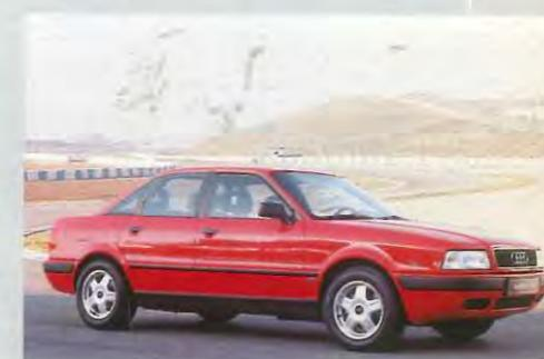
Acaba de presentarse el Audi 80 2.0 16 V, que completa la gama del más difundido de los modelos de la marca. Aporta un nuevo motor de 1.984 c.c., 16 válvulas y 140 CV de potencia, además de suspensión deportiva y un completo y lujoso equipamiento deportivo de serie.
