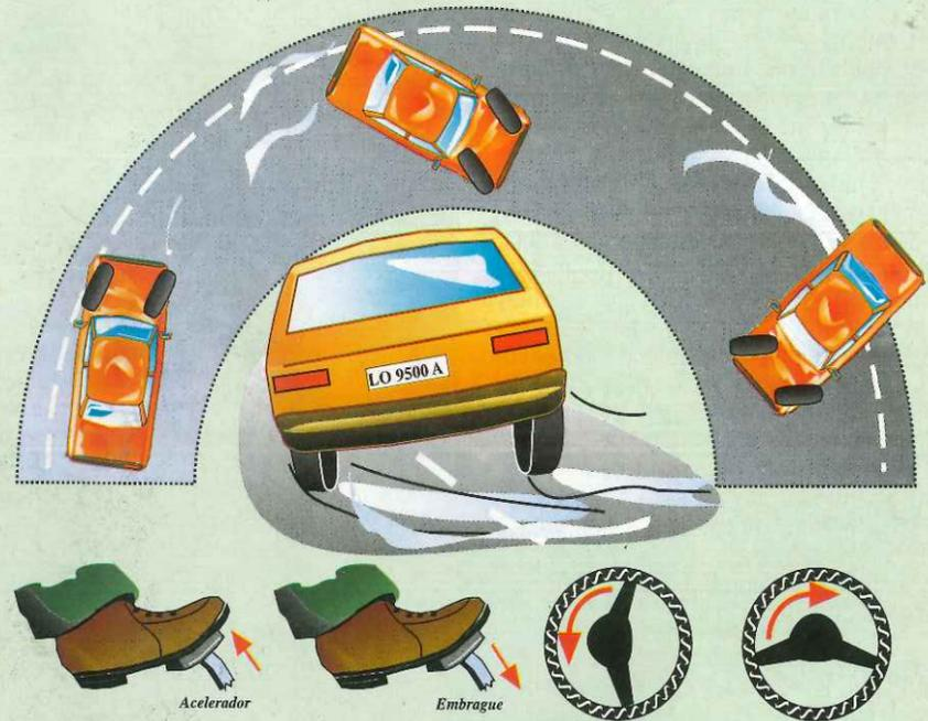
El sobreviraje es el coleo de la parte de atrás, generalmente en los vehículos con tracción trasera. El resultado es que la zaga del coche se ve impulsada hacia la parte exterior de la curva y la reacción instintiva de un conductor normal es frenar y -como muestra el gráfico-girar aún más el volante para tratar de que el vehículo no se salga. Precisamente, todo lo contrario a cómo debe actuar.
