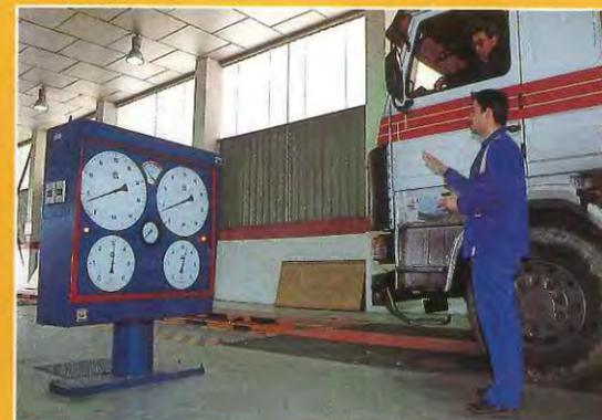
Prueba de frenos y comprobación de alineación de ejes.
