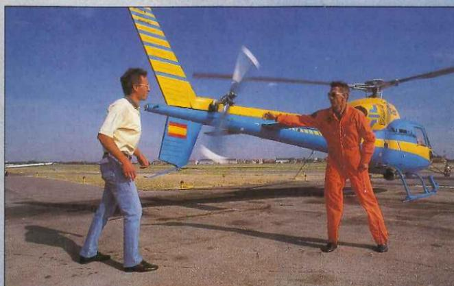
**CUCHILLAS EN LA COLA.** Nunca se acerque al helicóptero por la parte trasera; el piloto no le ve y las hélices del rotor le pueden partir en dos.
