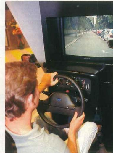
Un simulador de la conducción, dotado de todos los elementos comunes en cualquier vehículo: volante, pedales de freno, embrague, acelerador, palanca de cambio de marchas y una pantalla que actúa como supuesto parabrisas y en la que se van reproduciendo escenas como si de una situación real de conducción se tratara, es una de la última innovación técnica que se está intentando introducir en España y que probablemente serán indispensables en la autoescuelas en un futuro quizás próximo.
