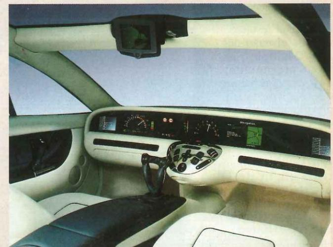
FUTURO. El prototipo Mercedes "F 200" no tiene volante ni pedales.
