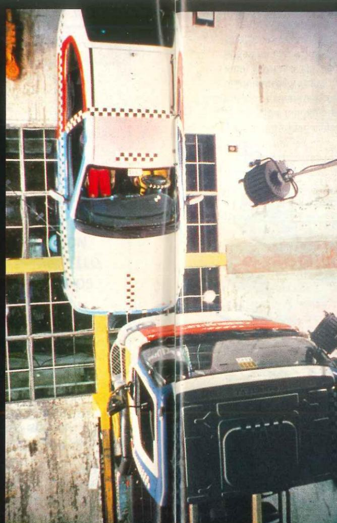
◆ **FRENTE A FRENTE.** En la desigual batalla, el pequeño lleva las de perder. Por ello, Renault ha diseñado un sistema antiempotramiento que disminuye el daño.
