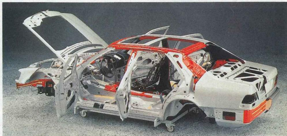
**DESEÑO.** La estructura ha de estar diseñada para absorber un golpe deformándose, pero sin que el habitáculo sufra intrusiones.
