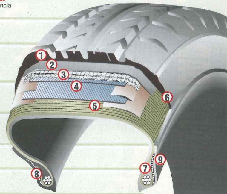
formada por un tubo de caucho unido en sus extremos y con una válvula para su hinchado. Este tipo de cámara se utilizó hasta la década de los años 50, en la que apareció el neumático sin cámara, conocido como "tubeless". Sus ventajas son muchas: reduce el peso, simplifica el montaje, disminuye el riesgo de reventón y, en caso de pinchazo, se deshincha muy despacio.
