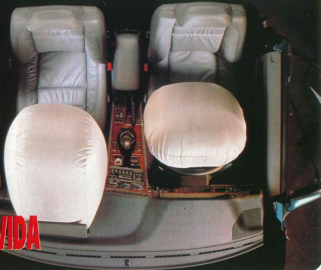
■ El airbag, en caso de accidente, absorbe la energía del cuerpo, impide que éste se mueva y se lesione.
