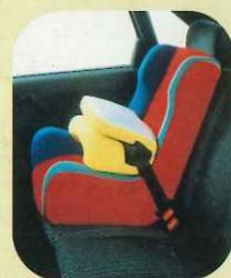
En un futuro próximo, los asientos especiales para niños llevarán su propio airbag. Sin embargo, el fabricante Bosch indica que, para que sean realmente eficaces, es necesario hacerlos compatibles con los del vehículo y adaptar su activación al comportamiento en choque del automóvil donde vayan a instalarse.
