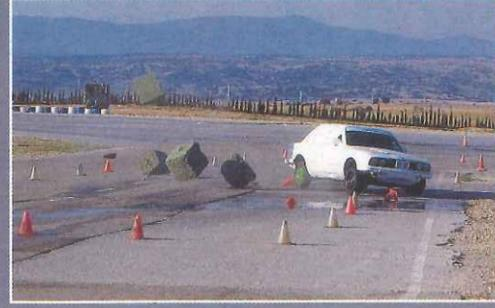
**MAL.** Con neumáticos traseros desgastados resulta imposible esquivar el obstáculo: el peso recae en el eje delantero por lo que las ruedas de atrás, sin apenas peso y dibujo, patinan. El derrape y la colisión son inevitables.
