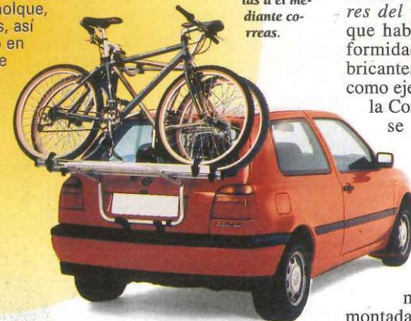
PORTÓN. Este modelo va anclado sobre el portón trasero y las bicis sujetas a él mediante correas.
