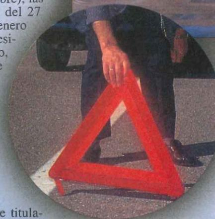
**TRIÁNGULO.** Todos los vehículos automóviles estarán obligados a llevar dos triángulos de preseñalización de peligro.
