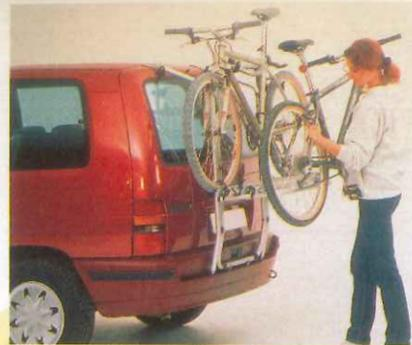
A LA CARROCERÍA. Se fijan a dos puntos de la carrocería del vehículo.
