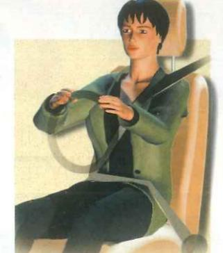
3 Asegúrese de que queda bloqueado: incline la cabeza hacia atrás con decisión. El reposacabezas debe mantener inalterable su posición.
