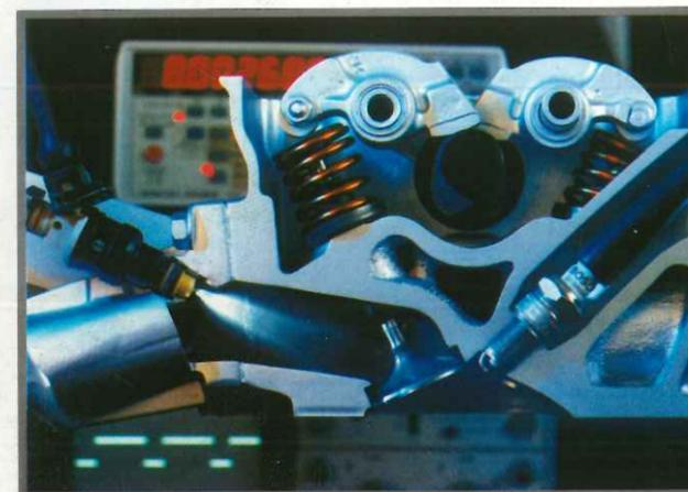
Sistema de inyección en un motor de gasolina.
