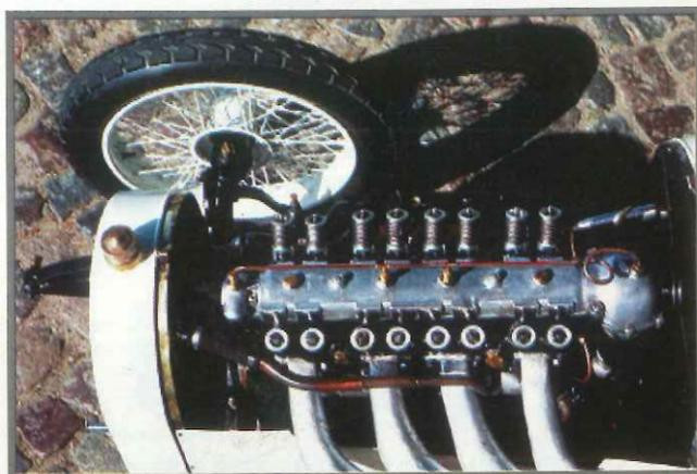
Primer motor de 16 válvulas fabricado por Opel en 1913
