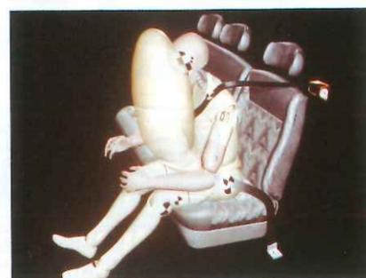
rón de seguridad. El airbag se hincha a partir de un generador de gas situado en el piso, garantizando una calidad de protección equivalente a la de las plazas delanteras.
