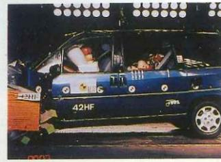
**IMPACTO FRONTAL:** El reposacabezas se desprende durante el choque. Las zonas rígidas, próximas a la columna de dirección, causan heridas en las rodillas y la deformación del suelo amenaza gravemente tanto a éstas como a los pies.
