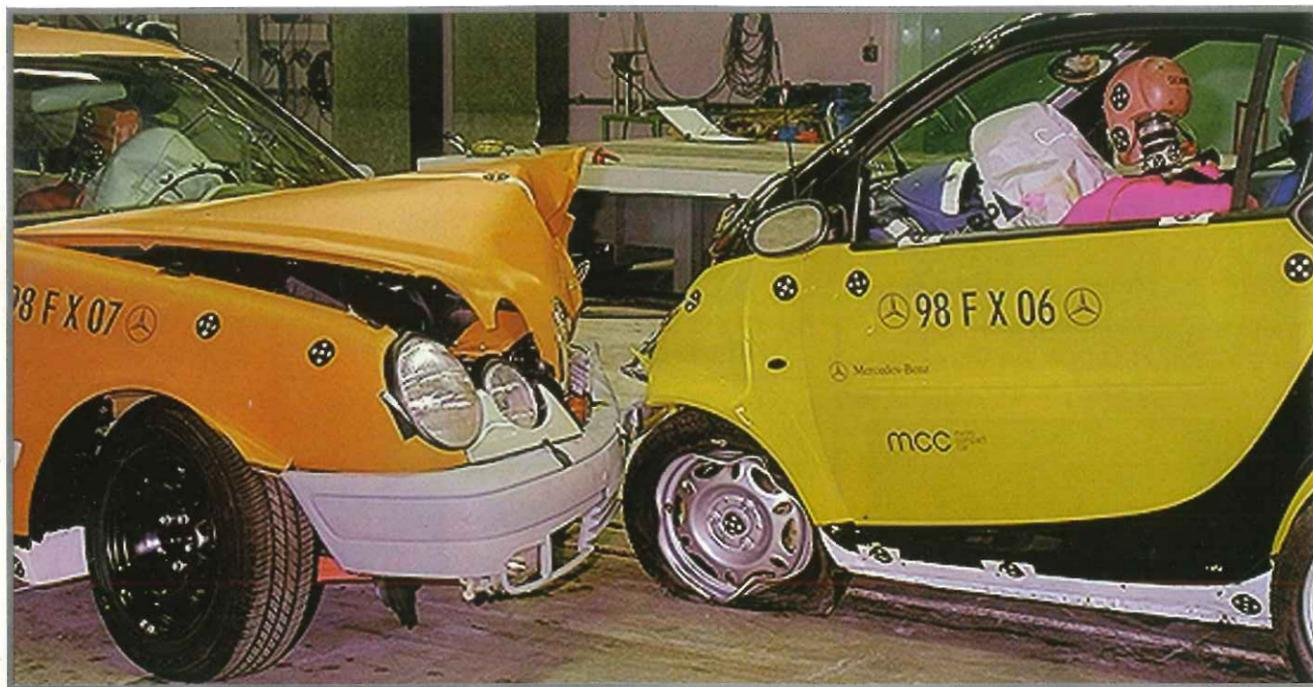
En los ensayos de choque se miden las lesiones que el cinturón evita y las que produce.
