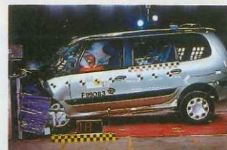
**IMPACTO FRONTAL:** El airbag se despliega irregularmente y la cabeza no es acogida correctamente. Las estructuras rígidas del salpicadero amenazan la seguridad de las rodillas. Es el único modelo en el que el suelo se mantiene lo suficientemente intacto como para no provocar ninguna lesión.
