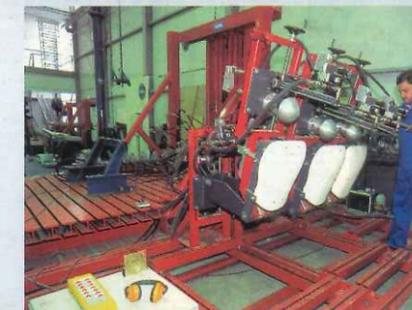
▶ **ENSAYOS.** Por último, una Área de Ensayos de Seguridad y Homologaciones estudia la adecuación a las normas de elementos tales como cinturones de seguridad, anclajes de los mismos, reposacabezas, asientos delanteros y traseros, salpicaderos, etcétera, para que no resulten peligrosos para los ocupantes de los vehículos y les protejan de forma adecuada.
