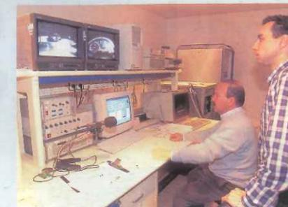
entre automóviles; es decir, que los elementos de un vehículo no dejen de funcionar correctamente cuando reciben ondas electromagnéticas (como las que emiten antenas, escaners de hospitales o simples teléfonos móviles, por ejemplo) ni que sus elementos produzcan interferencias en los demás automóviles. Para ello, este área cuenta con una cámara anecoica con las dimensiones para albergar no sólo vehículos, sino aviones y otros elementos de grandes dimensiones.
