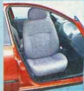
**ASIENTO GIRATORIO.** Para facilitar el acceso al interior del vehículo, el asiento original del coche puede fijarse sobre una base giratoria que permite una rotación del mismo de 90 ó 120°
