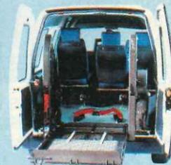
**PLATAFORMAS Y RAMPAS.** Existen vehículos ya adaptados que permiten alojar en su interior una silla de ruedas. El acceso se realiza mediante una plataforma o a través de una rampa de aluminio que salvan el desnivel piso-suelo.
