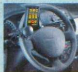
**MANDO DE RAYOS INFRARROJOS.** Aquellas personas que sólo tienen una mano válida, pueden mover el volante con un pomo y con el mando de rayos infrarrojos accionar los dispositivos secundarios: luces, intermitentes, claxon.
