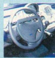
**FRENO Y ACELERADOR EN EL VOLANTE.** Los pedales (freno y acelerador) son sustituidos por mandos situados en el volante (un aro y diferentes palancas). También es posible utilizarlo en coches con airbags, porque se puede instalar un aro ya preparado.
