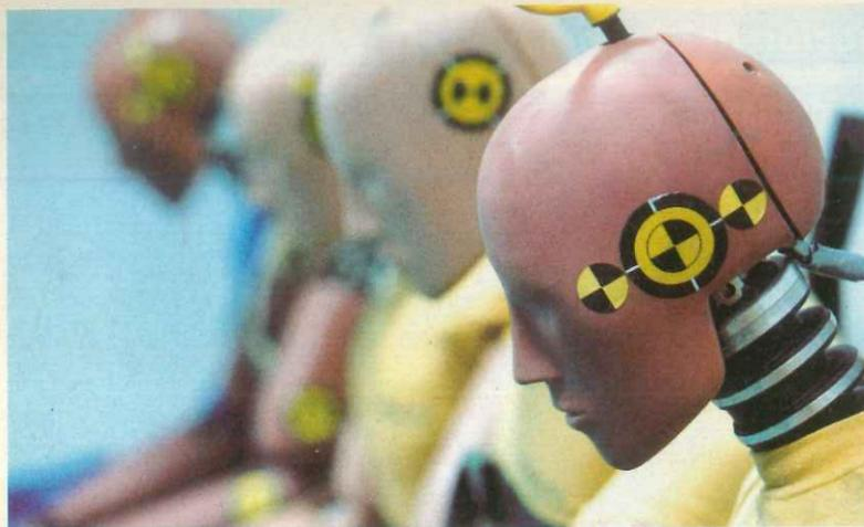
**DUMMIES.** Coches ocupados por dummies se estrellan, de frente o de lado, mediante una catapulta de impacto que permite velocidades de hasta 80 km/h.
