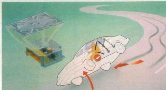
detectar el tipo de vuelco y efectuar un cálculo de probabilidades. Si ambos cálculos indican que se va a producir un vuelco, los dispositivos de seguridad (tensores de los cinturones, airbags frontales y barras de protección antivuelcos) se activan a tiempo, reduciendo el riesgo de lesiones. Según Bosch, este tipo de accidentes supone un 20 por 100 del total de la siniestralidad.
