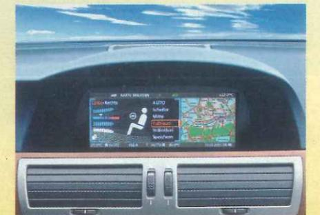
**TEMPERATURA INDIVIDUALIZADA.** Distribuye la circulación del aire entre las diversas zonas del habitáculo de modo individual, con diferenciación entre la zona de la cabeza y tórax y la de los pies, entre el lado izquierdo y el derecho y entre la parte delantera y trasera.
