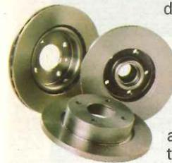
su interior conductos para el paso del aire, deforma que se disipe más rápidamente el calor. De esta forma se pueden utilizar pastillas de materiales más duros, con lo que se aumenta el rendimiento de los frenos.
