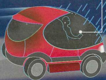
**ACCIDENTE.** El conductor es avisado de un accidente, varios kilómetros más adelante. El sistema lo ha identificado y localizado a través de distintos medios (por ejemplo, por la deceleración brutal de uno de los millones de puntos móviles que controla).
