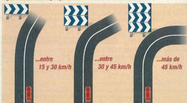
Asimismo, con el fin de guiar al conductor y marcarle el trazado de la curva, se colocan paneles direccionales a lo largo delimitando el exterior de la misma. Aunque el primero sea doble o triple, el resto son sencillos, y están separados entre sí por una distancia del orden del 20% del radio de la curva y, en todo caso, superior a 10 m.
