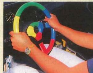
■ **Holgura del volante.** Reglaje del engranaje defectuoso o desgaste de articulaciones.
