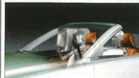
hacia arriba. Su diseño es muy rígido para que pueda mantenerse en posición vertical. Ofrece protección aunque la ventana lateral esté abierta o rota. Incluso, asegura Volvo, protege en caso de que produzca una vuelta de campana.
