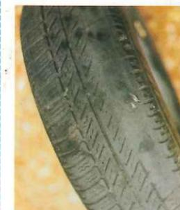
**9** Si se observa que el borde exterior de la banda de rodadura del neumático está desgastado excesivamente, se deberá...
