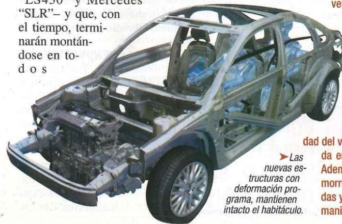
Las nuevas estructuras con deformación programada, mantienen intacto el habitáculo.
