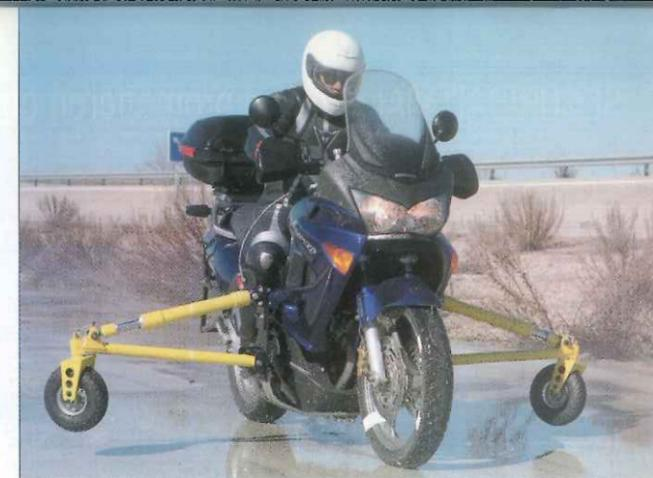
► Rampas pronunciadas para los todoterreno, a la izquierda, y pista especial de frenado ABS para las motocicletas.
