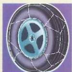
**5** Vigile el estado de las cadenas de nieve. Un borde cortante o un eslabón roto puede perforar el neumático al utilizarlas.
