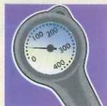
**1** Vigile regularmente la presión. Al salir de viaje y con el coche cargado al máximo, aumente la presión siguiendo las indicaciones del fabricante. Compruebe siempre la presión en frío.
