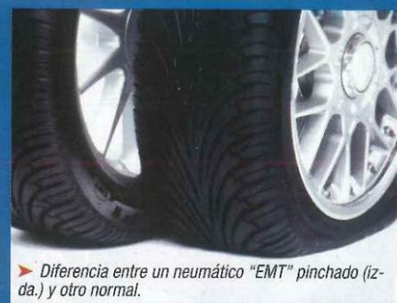
► Diferencia entre un neumático "EMT" pinchado (izda.) y otro normal.
