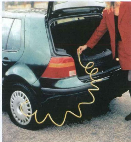
► Si está desinflado, con un tubo puede compensar su presión con la de la rueda de repuesto.
