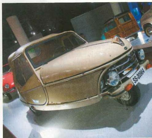
► El "Clúa" empleaba un motor bicilíndrico de 247 c.c. Sus líneas armoniosas le constituyeron en el deportivo de los microcoches. Entre sus prestaciones destacaban la suspensión independiente, el arranque eléctrico, sus cuatro velocidades y la marcha atrás.
