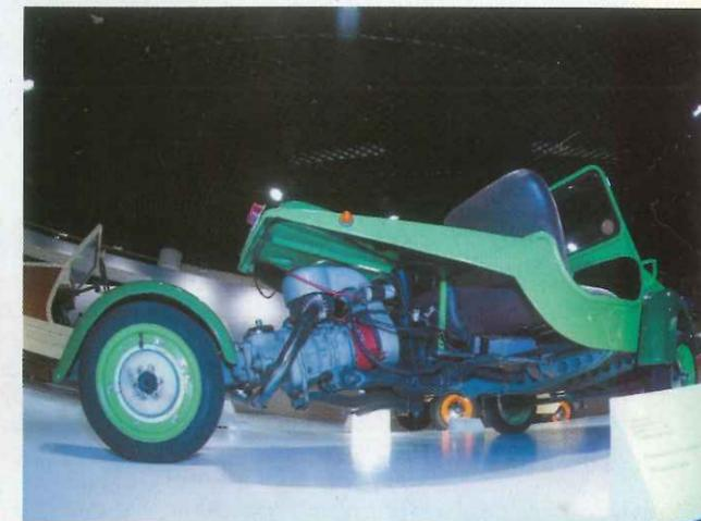
► El "Mototriciclo" era un vehículo de encargo. La tecnología parte de la motocicleta. Con un motor monocilíndrico de dos tiempos, de 175 cc, podía alcanzar los 65 km/h. Llegaron a fabricarse 20 unidades.
