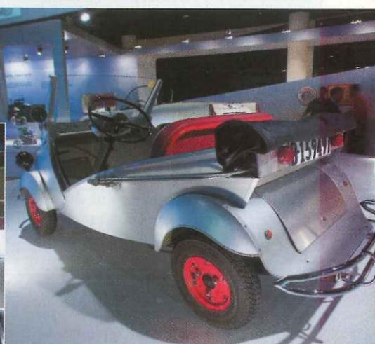
► El "Delfin Tricamioneta" era un vehículo para soluciones polivalentes, muy utilizado en fábricas de pan. Su diseño corresponde al catalán Julio Fusté. Con un motor de 197 cc, tenía el depósito del carburante en la parte derecha del salpicadero. Sólo se fabricaron 20 unidades.
