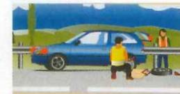
**5. BÁJELO.** Baje el coche y retire el gato para apretar con firmeza las tuercas. Guarde la rueda pinchada y no se olvide recoger los triángulos de peligro.
