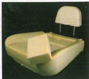
Además de cuidar el medio ambiente —las fibras vegetales son un recurso renovable y sostenible—, disminuyen el peso del coche (hasta un 30%), lo que revierte en un ahorro de combustible, e incrementan la seguridad, ya que las fibras naturales son capaces de absorber la energía de forma muy eficaz en colisiones laterales y no se agrietan ni astillan. En la actualidad, el 85% del volumen de un Volvo es reciclable.
