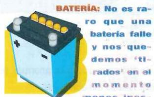
**BATERÍA:** No es raro que una batería falle y nos quedemos 'tirados' en el momento menos inesperado. Pida que se la miren si lleva el coche al taller: importante comprobar el nivel de líquido en los vasos, los bornes y el nivel de carga, aunque sea una batería de bajo mantenimiento.
