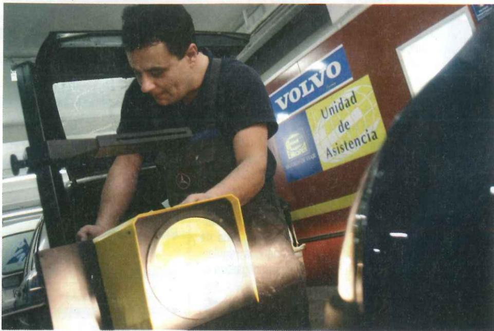
**ANTES DE SALIR.** Compruebe que todas las luces de alumbrado y señalización funcionan correctamente, delante y detrás. Regule la altura de las luces si ha cargado el maletero.
