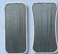
Neumático desgastado y neumático desgastado con poca presión
