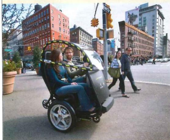
Su nombre es PUMA y ha sido desarrollado conjuntamente por General Motors y Segway. Es un vehículo eléctrico de dos plazas y dos ruedas, capaz de conducir y aparcar autónomamente. Lleva una batería de ión litio y un sistema que le permite comunicarse con otros vehículos y saber dónde hay atascos. También equipa un dispositivo que detecta donde están el resto de objetos móviles y evita colisionar con ellos. Puede alcanzar 56 km/h y tiene una autonomía de 56 kilómetros entre recargas.
